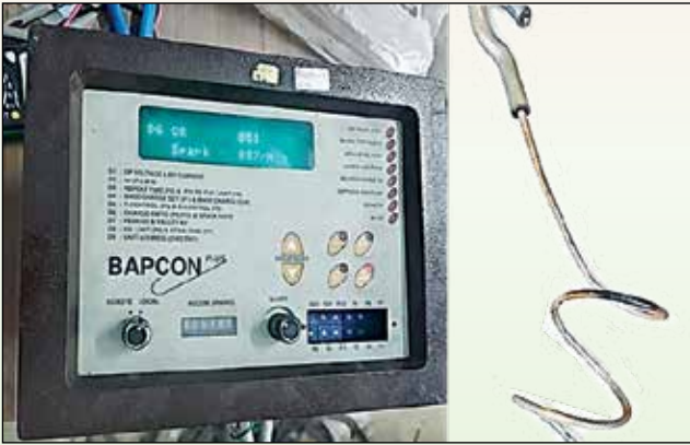
चित्र 5 में स्पार्क इरोजन टेस्ट मॉनिटर और वायर पर उत्पन्न स्पार्क दिखाए गए हैं।
